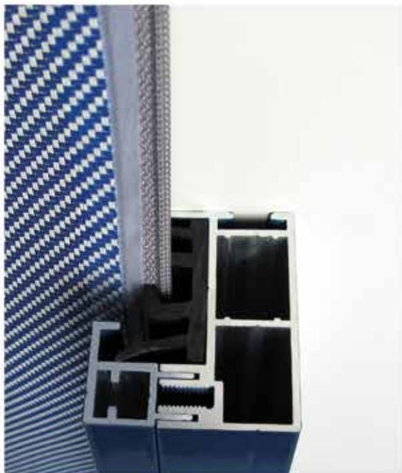
Der seitlich fixierte Behang sorgt für eine stabile Tuchspannung. Auch bei hohen Windlasten (Windwiderstandsklasse 6 nach DIN 13659) bleibt das Tuch sicher und fest gespannt in der Führung.
