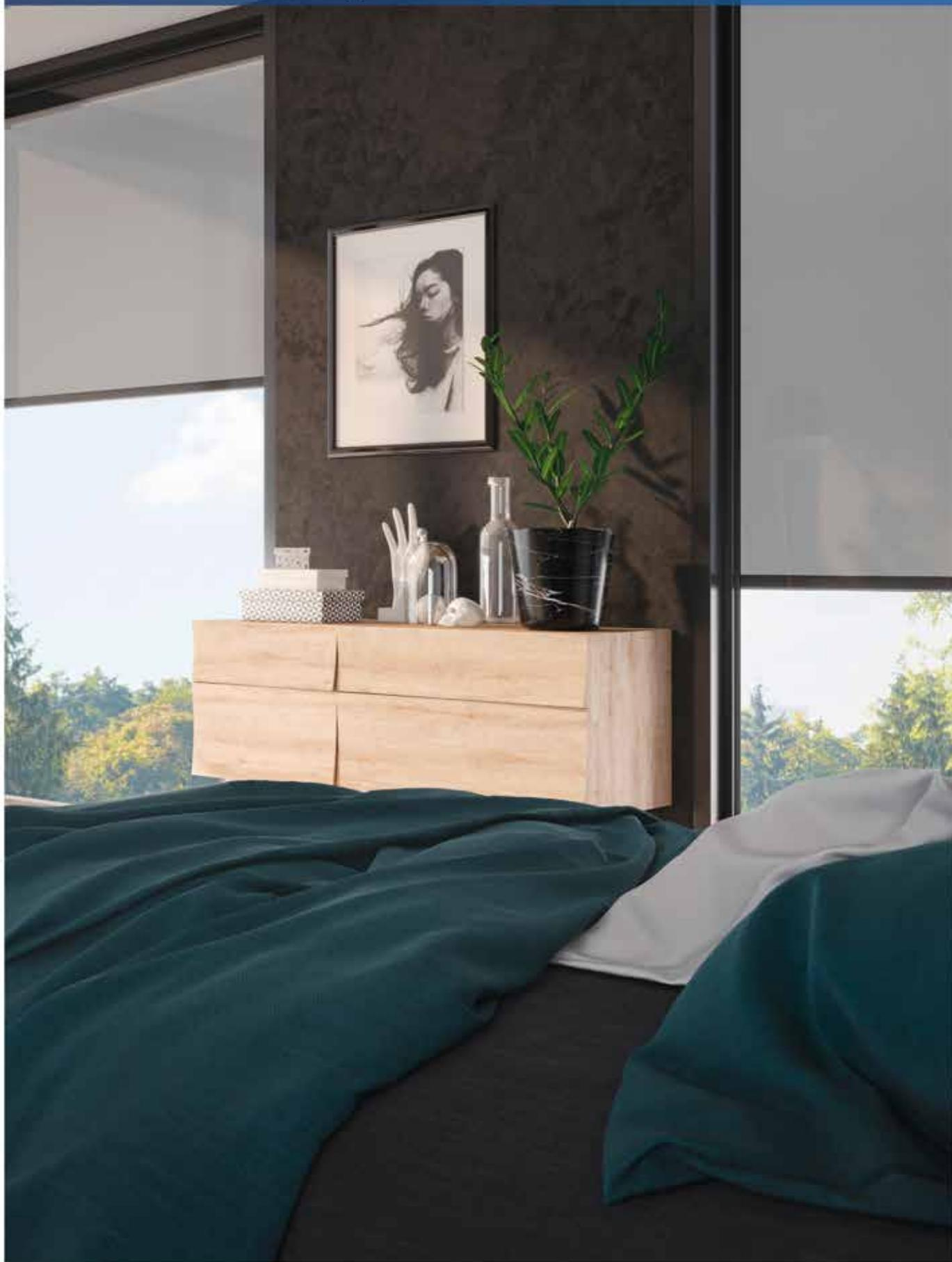
Je nach eingesetzter Tuchvariante werden die Räume von mehr oder minder gedämpftem Tageslicht durchflutet. Gleichzeitig **reduziert sich die solare Wärmeeinstrahlung** durch die Montage außen vor dem Fenster, was den Aufwand für Raumkühlung deutlich vermindert.
